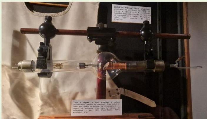
Tube à rayons X type Coolidge pour l'étude de la structure des cristaux
